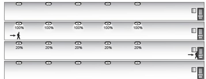
Falls der Lux Wert des Umgebungslichtes tiefer ist als der eingestellte Lux Wert, schaltet die Slimled kein Standby Licht ein! Erst die Detektion einer Bewegung löst eine Schaltung aus.
