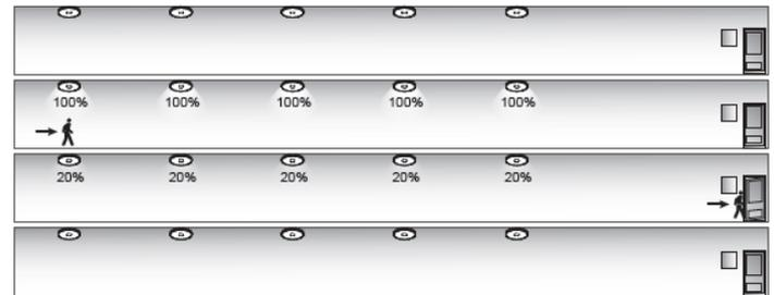
Si la luminosité de la pièce est inférieure à la valeur de luminosité réglée, le Slimled n'allume aucune lumière de veille ! Seule la détection d'un mouvement déclenche un circuit.
