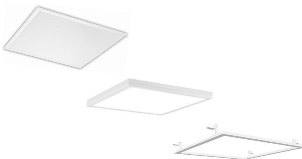
Bracopanel LED Einbau- Aufbau oder Pendelmontage, UGR<19, Ra90
